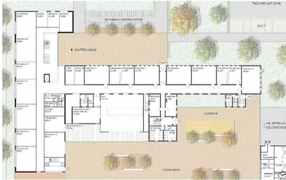
GRUNDRISS ERDGESCHOSS MIT AUSSENANLAGEN 1.250 2-ZÜGIG
